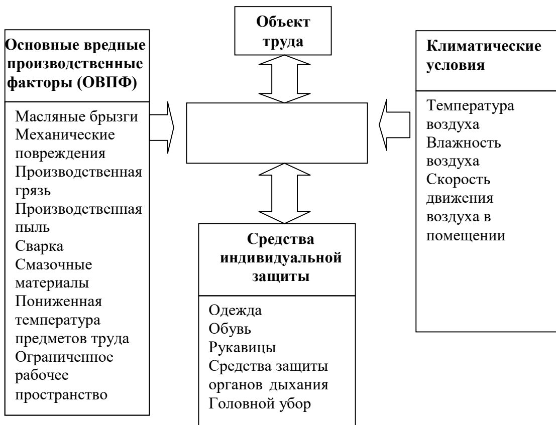
Рисунок 1 Схема влияния основных вредных производственных и климатических факторов (ОВПФ) при выполнении технологических операций
