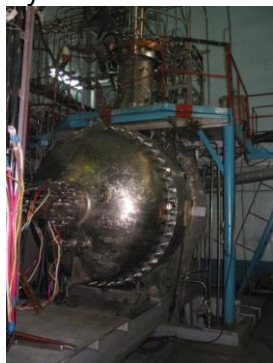
1 – ЭПП (электрическая плавильная печь), 2 – тигель графитовый, 3 – индуктор ЭПП, 4 – УПР (устройство приема расплава), 5 – индуктор УПР, 6 – бетонная ловушка.
