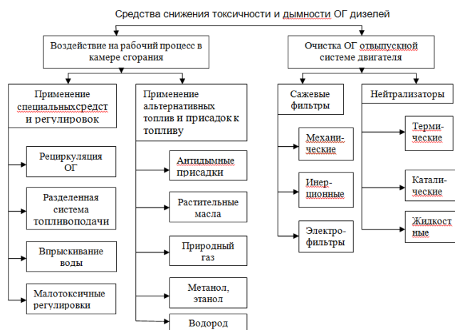
Рисунок 1 – Средства снижения токсичности и дымности ОГ дизелей
