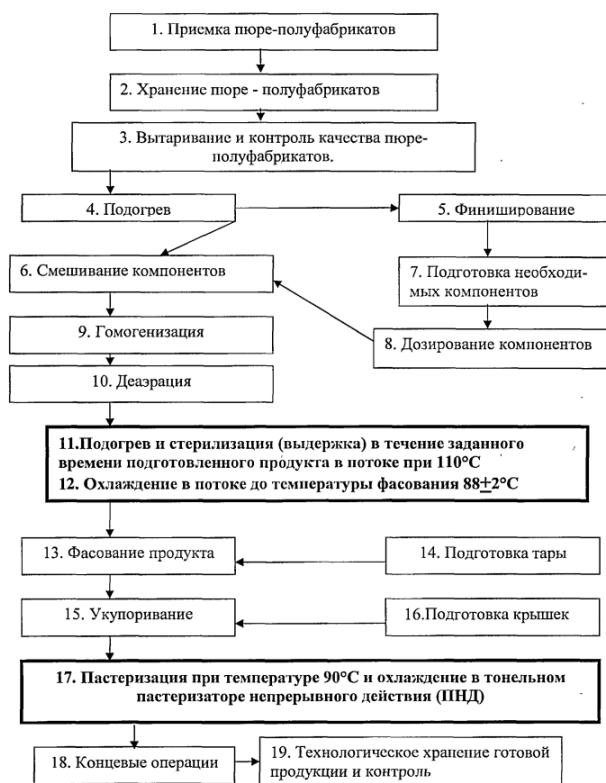
Рисунок 3 – Усовершенствованная технологическая схема производства консервов на фруктовой основе
