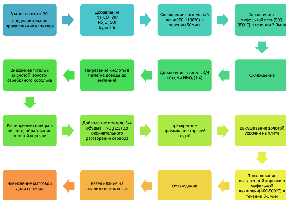
Рисунок 1 – Схема анализа текущего клинкера цинкового производства на содержание благородных металлов
