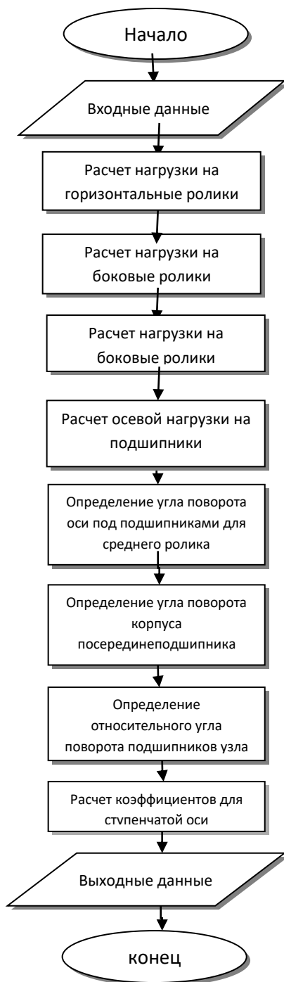
Рисунок 2 – Блок-схема алгоритма для расчета нагрузки на подшипник
